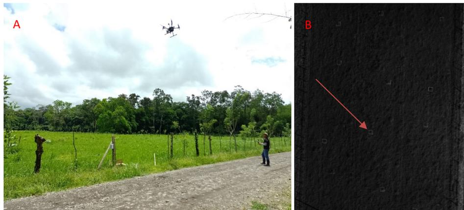
Figura 3. A: Levantamiento fotogramétrico con dron para la estimación de biomasa en pasturas; B: cuadros de muestreo distribuidos previo al vuelo.
