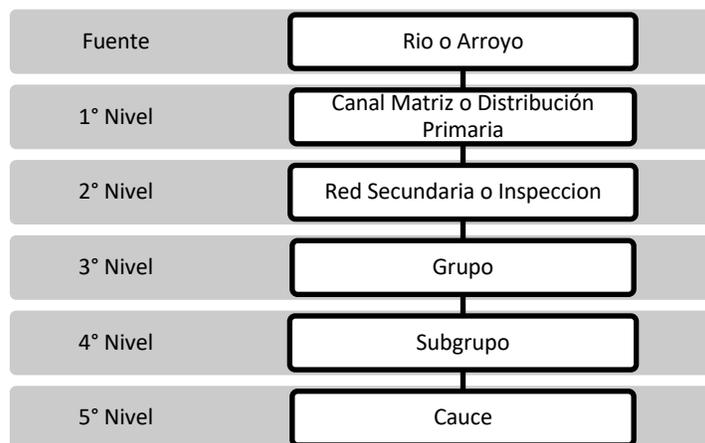
**Figura 7.** Esquema de la estructura de las redes de distribución secundaria.
