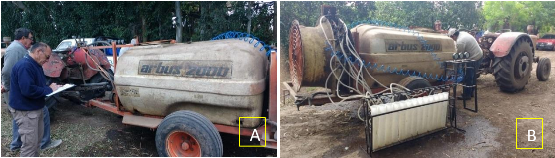
Imagen 10. A) Calibración de la pulverizadora Jacto arbus 2000. B) Evaluación de volumen arrojado por los picos. San Pedro, Buenos Aires, Argentina.
