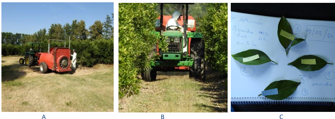
Imagen 1. A) Equipo pulverizador FMC de 2000L. B) Personal aplicador con las medidas de seguridad en la aplicación BPA. C) Tarjetas hidrosensibles para evaluación de calidad de aplicación. Lote Demostrador, Concordia Entre Ríos, Corrientes Argentina.
