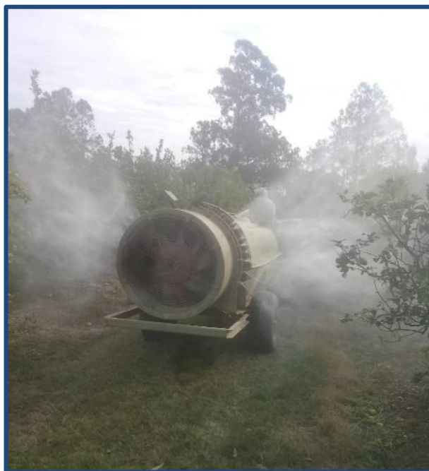
Imagen 16. Equipo pulverizador Jacto 2000 con turbina, picos J4. Lote Demostrador. Colonia 3 de Abril, Bella Vista, Corrientes, Argentina.
