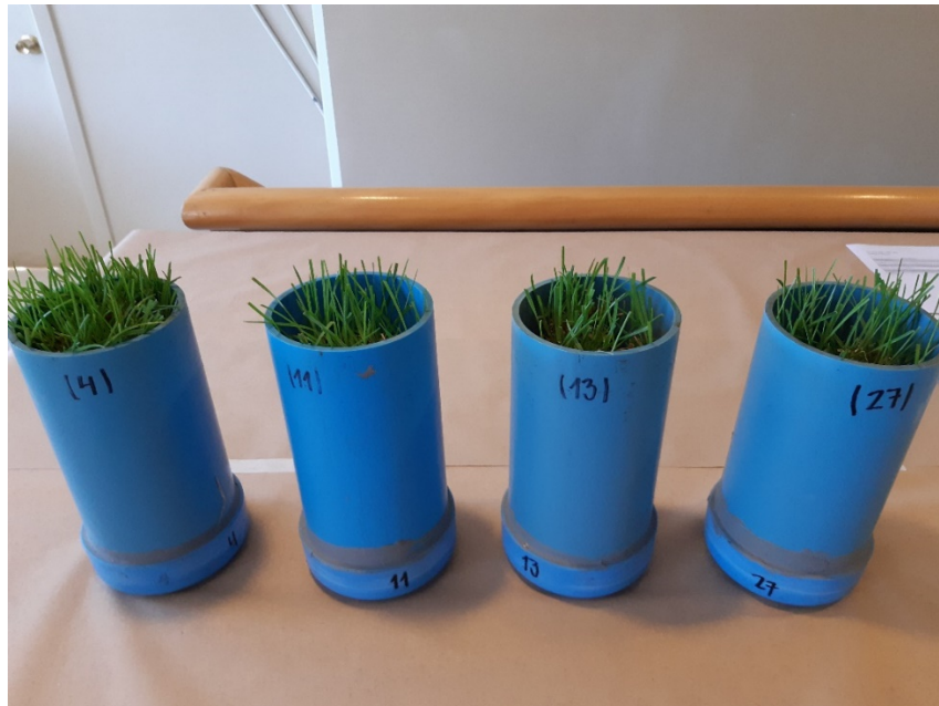
Figura 2. Bloques intactos de suelo con pradera permanente en lisímetros de PVC utilizados para ensayo de emisiones de gases efecto invernadero y amoníaco.
