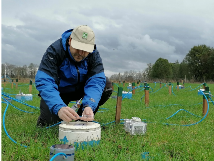
Figura 10. Muestreo de gases efecto invernadero en pradera permanente.
