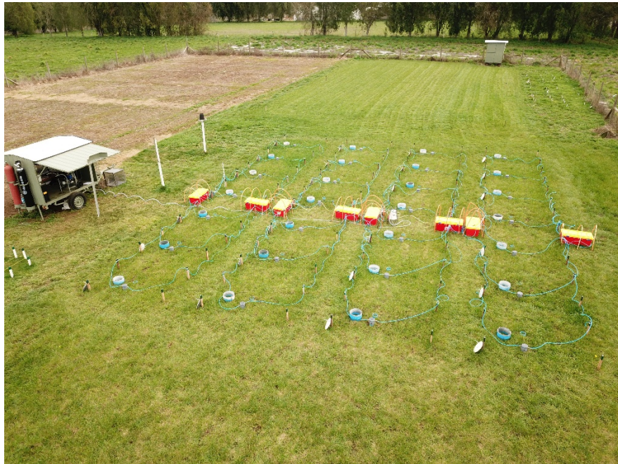
Figura 9. Vista general del ensayo de campo evaluando pérdidas de gases efecto invernadero y amoníaco por la aplicación de fecas y orina sobre pradera permanente.
